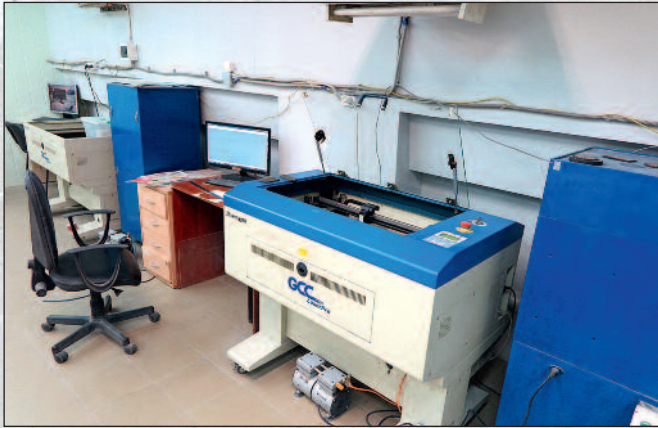
Слева: Оборудование для лазерной резки неметаллических материалов. Справа: Один из участков механической обработки деталей.
